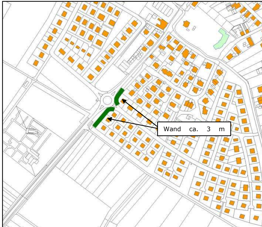
Abbildung 20: Lage und Höhe der Schallschutzwände
