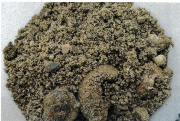
Abbildung 1: **Auffüllung - Mischprobe**
