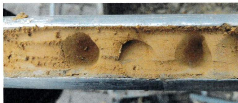
Abbildung 5: **Abschwemmmassen (weich) - Kleinbohrung**
