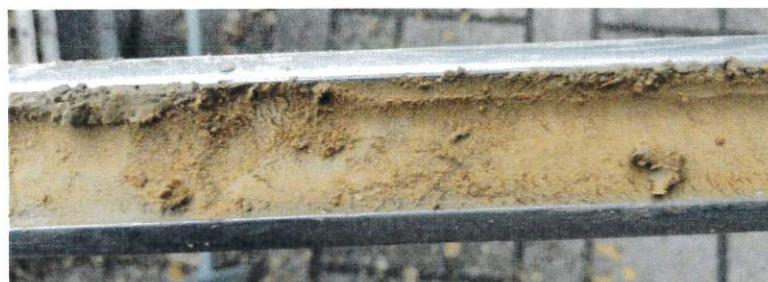
Abbildung 4: **Abschwemmmassen (steif bis halbfest) - Kleinbohrung**
