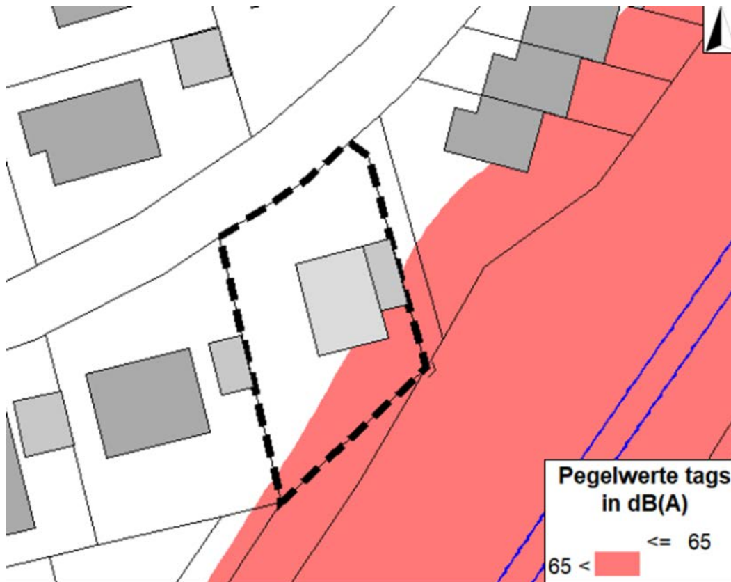
Abbildung 10: Bereich mit Überschreitung der Lärmwerte von 65 dB(A) tags zur zum Schutz der Außenwohnbereiche; Quelle: Ingenieurbüro für Umweltakustik Heine + Jud, 04.02.2022
